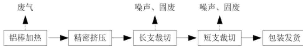
图 2-6 初级电子型材工生产线工艺流程图
